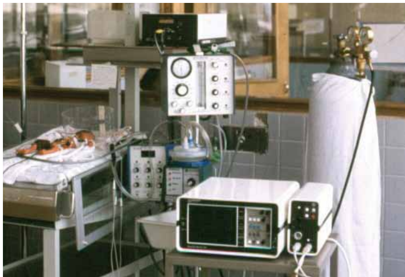
1.5 El primer ventilador mecánico que tuvo la UCIN del HCAM fue el Bourns BP 200 de manejo fácil y comprensible. Fue de gran utilidad.
