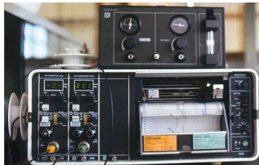
1.7 Monitor transcutáneo de PO_2 y PCO_2 dotado de registro de las variables.
