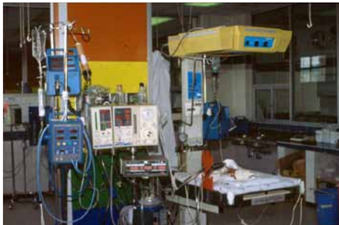
1.11 Cuidados Intensivos Neonatales en el HCAM a partir de la remodelación concluida en 1993. Constan bombas de infusión Abbot, monitor de tensión arterial Dinamap y ventilador Bear Cub con su monitor de volumen (abajo) y módulo (derecha) que conectado a la unidad principal permitía seleccionar modalidades ventilatorias como: asistida/ controlada, IMV sincronizada y CPAP.
