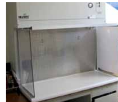
1.26 Vista de campana de flujo laminar
